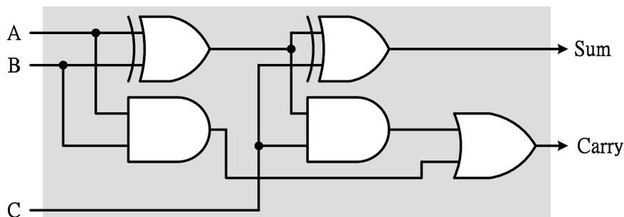
請利用IC7408、IC7432、IC7486組合出全加器的電路，並使用LED燈顯示結果，將輸出結果填入下表，並與前一頁之真值表對照以驗證結果的正確性。
