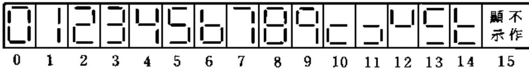
IC 7447的功能是將BCD碼轉至七段顯示器(共陽極)的控制電路，請同學依序將IC 7447各接腳接至七段顯示器所對應的接腳，並利用IC 7447的輸入來驗證結果的正確性，最後將實習題(二)的輸出接至實習題(三)。
